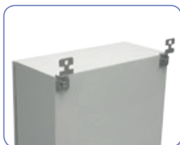
Montáž k stene – priama alebo pomocou špeciálnych montážnych držiakov (osobitná objednávka). Otvory v zadnej stene telesa s priemerom 10 mm.
