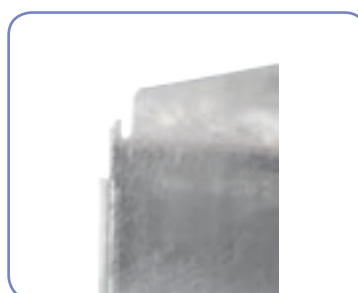
Montážna doska je vyrobená z pozinkovaného plechu s hrúbkou 2 mm. Pripevnenie montážnej dosky pomocou hmoždínok M8x25. V závislosti od veľkosti je doska na hranách ohnutá, čím sa zvyšuje jej tuhosť.
