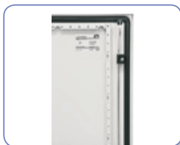
Dvierka skriniek od šírky 800 mm majú vodorovné profily s montážnymi otvormi vo vzdialenosti 25 mm jeden od druhého.
